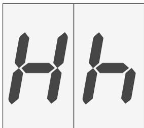
Il piano di cottura è dotato di un indicatore di calore residuo per ciascuna zona di cottura. Tale indicatore segnala quali zone di cottura hanno ancora una temperatura elevata. Pertanto evitare di toccare queste zone di cottura.
