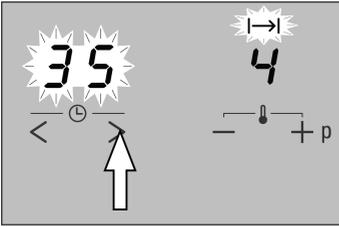
4. Het symbool < of symbool > aanraken, tot de gewenste tijdsduur in de timer-indicatie verschijnt. De tijdsduur knippert enkele seconden en loopt vervolgens af.
