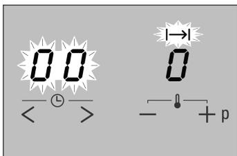
Quando il programma Memory è terminato, la zona di cottura si disattiva. Risuona un segnale acustico. Sul display del timer lampeggia 00. Il display I→I della zona di cottura lampeggia. Sul display delle zone di cottura lampeggia uno 0.
