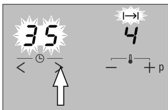
4. Effleurer le symbole < ou le symbole > jusqu'à ce que la durée souhaitée apparaisse à l'affichage de minuterie. La durée clignote pendant quelques secondes et s'écoule ensuite.
