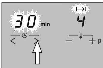
3. Sfiocare i simboli < oppure >. Appare il valore raccomandato. Con >: 30 minuti con <: 10 minuti Il display I→I per la zona di cottura continua a lampeggiare.
