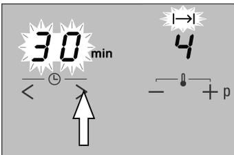
3. Het symbool < of symbool > aanraken. De voorgestelde waarde wordt weergegeven. Bij >: 30 minuten
