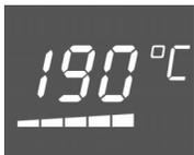
Le témoin de chauffe indique la montée en température dans le four. Le moment optimal pour enfourner le plat est atteint lorsque toutes les cases sont remplies.
