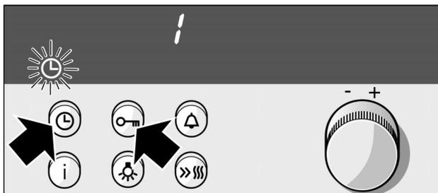
2. Modifier le réglage de base au moyen du bouton rotatif.
