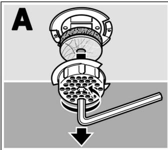
**1.** Avec une clé à six pans (6 mm), tourner le carter de filtre à gauche et l'enlever. Fig. A.
