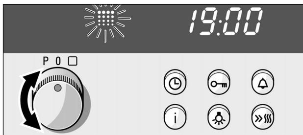
2. A l'aide du bouton rotatif, régler la puissance de nettoyage souhaitée.
