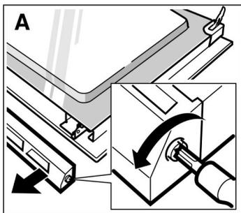
1. Démontez la porte du four et la placez avec la poignée vers le bas sur un chiffon.
