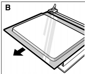
3. Soulever la vitre supérieure et la retirer (Fig. B)
