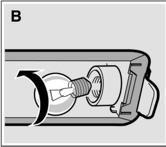
4. Dévisser l'ampoule et la remplacer par un type d'ampoule identique. Fig. B.
