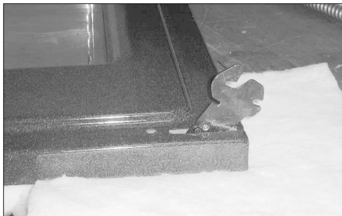
Foto B. Inserte la bisagra de la puerta en la ranura en el bastidor delantero.
