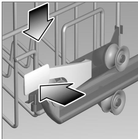
– Zum Absenken drücken Sie nacheinander die beiden Hebel links und rechts auf der Korbaußenseite nach innen. Halten Sie dabei jedes Mal den Korb seitlich am oberen Rand mit der Hand fest. So vermeiden Sie, dass der Korb ruckartig nach unten fällt (und eventuell Geschirr beschädigt wird).
