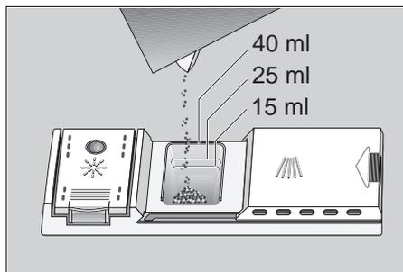
Sollte die Reinigerkammer  noch geschlossen sein, betätigen Sie den Verschlussriegel , um sie zu öffnen.
