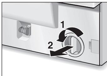
Desmontar cuidadosamente la tapa de la bomba de evacuación. Puede salir un poco de agua residual.
