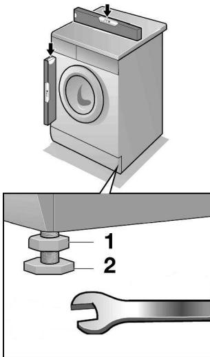
Ευθυγραφαμίστε το πλυντήριο με τη βοήθεια των ρυθμιζόμενων ποδιών και ενός αλφαδιού:
