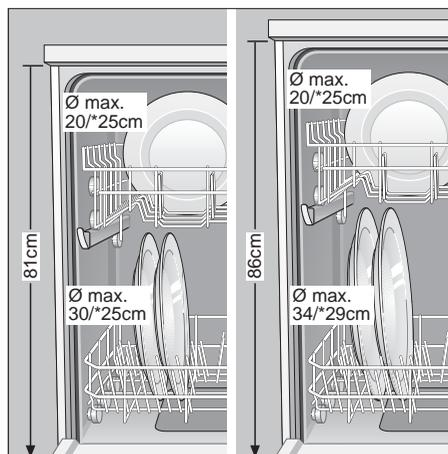
El cesto superior se puede colocar sobre los rodillos superiores o inferiores a fin de disponer de más espacio útil en el cesto superior o inferior para colocar piezas de vajilla altas.
