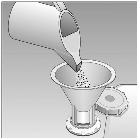
El piloto de aviso de la reposición de la sal **4** en el cuadro de mandos se ilumina y se apaga sólo al cabo de cierto tiempo, una vez que la concentración de sal en el agua de la instalación de descalcificación ha alcanzado una concentración suficiente.
