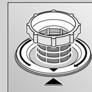
enroscar el filtro cilíndrico
