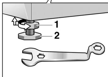
Ajustez l'horizontalité du lave-linge au moyen de ses quatre pieds à vis réglables et d'un niveau à bulle.
