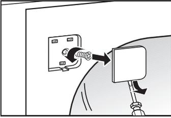
1. Enlevez les deux caches du système de fixation de la porte : A l'aide du tournevis à fente, dégagez les caches avec précaution.
