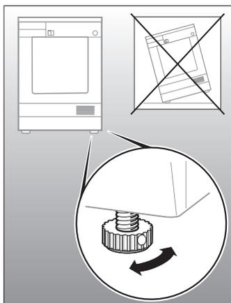
1. Le sol doit être propre, plan et solide.
