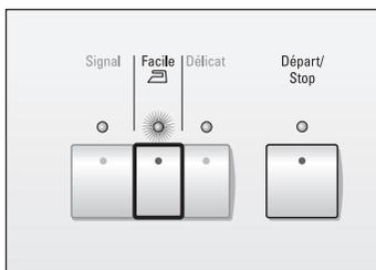
La fonction **Facile** réduit le froissage du linge. La durée du séchage augmente.
