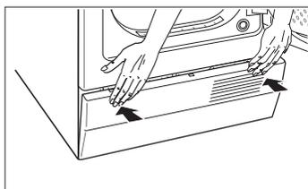
11. Pour refermer la trappe, appuyez simultanément côté gauche et côté droit jusqu'à ce qu'elle s'enclenche.
