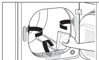
Après une plus longue durée d'utilisation, une fine couche de calcaire peut se former sur les capteurs d'humidité côté intérieur de la paroi avant de l'appareil.
