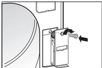
6. Refixez le système de fermeture de l'autre côté. Remettez le cache en place et resserrez la vis.
