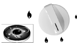
De binnenste kroon brandt met maximaal vermogen; de buitenste kroon is uitgeschakeld.
