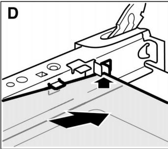
1. Die untere Glasscheibe schräg nach hinten einschieben. (Bild D)
