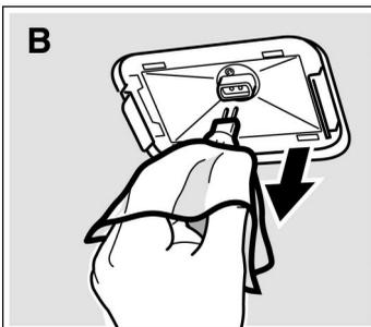
4. Die Lampe herausziehen - nicht drehen - und die neue Lampe einsetzen. Bild B. Dabei auf die Stellung der Stifte achten. Lampe fest eindrücken.
