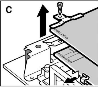
4. Die großen Klammern links und rechts aufschrauben und entfernen. (Bild C) Die mittlere Scheibe herausnehmen.
