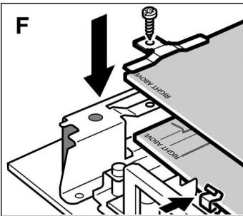
4. Die kleinen Klammern wieder an der unteren Glasscheibe aufstecken. (Bild F)
