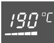
Die Aufheizkontrolle zeigt den Temperaturanstieg im Backofen an. Wenn alle Felder gefüllt sind, ist der optimale Zeitpunkt zum Einschieben des Gerichtes erreicht.
