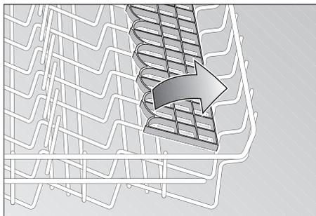
I pezzi lunghi, posate di servizio e per insalata, mestoli o coltelli, vanno sistemati sull'étagère, per non impedire la rotazione del braccio di lavaggio. L'étagère può essere abbassata o alzata a discrezione.
