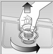
Siebzylinder drehen, Siebsystem entnehmen ...
