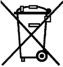
"Dieses Gerät ist entsprechend der europäischen Richtlinie 2012/19/EU über Elektro- und Elektronikaltgeräte (waste electrical and electronic equipment - WEEE) gekennzeichnet.
