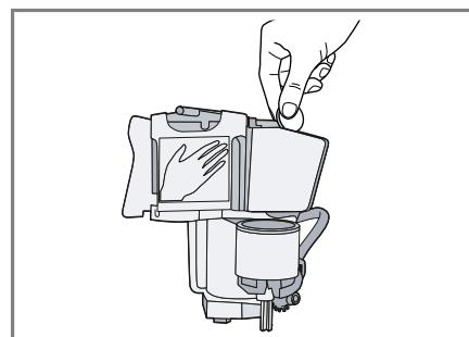
6. Posudu za kapanje i spremnik za talog ponovno umetnите u uređaj i zatvorite vrata.
