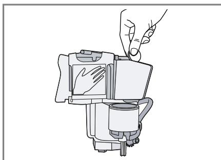
6. Ponovno vstavite odkapno posodo in posodo za kavno usedlino in zaprite vrata.
