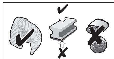
■ Pyyhi pois välittömästi kalkin, kahvin, maidon ja kalkinpoistoaineen jäämät. Tällaiset jäämät saattavat aiheuttaa korroosiota.
