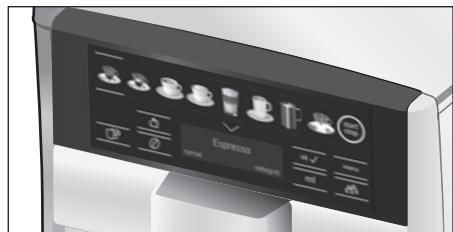
**i** Den helautomatiska espressobryggaren har av tillverkaren programmerats med standardinställningarna för optimal drift. Apparaten stängs automatiskt av efter en förinmatad tid (se kapitlet "Meny – Autom. avstängning").
