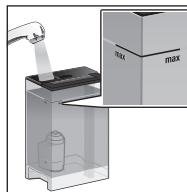
Зніміть резервуар для води і наповніть його холодною водою до позначки «max».
