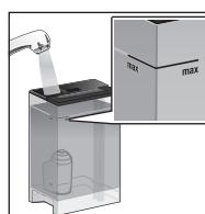
ขณะนี้ให้นำภาชนะบรรจุน้ำไปเติมน้ำเย็น จนถึงเครื่องหมาย “max”
