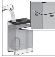
Теперь выньте емкость для воды и наполните ее холодной водой до отметки «max».
