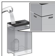
Neem vervolgens het waterreservoir uit het apparaat en vul het tot aan de markering "max" met koud water.
