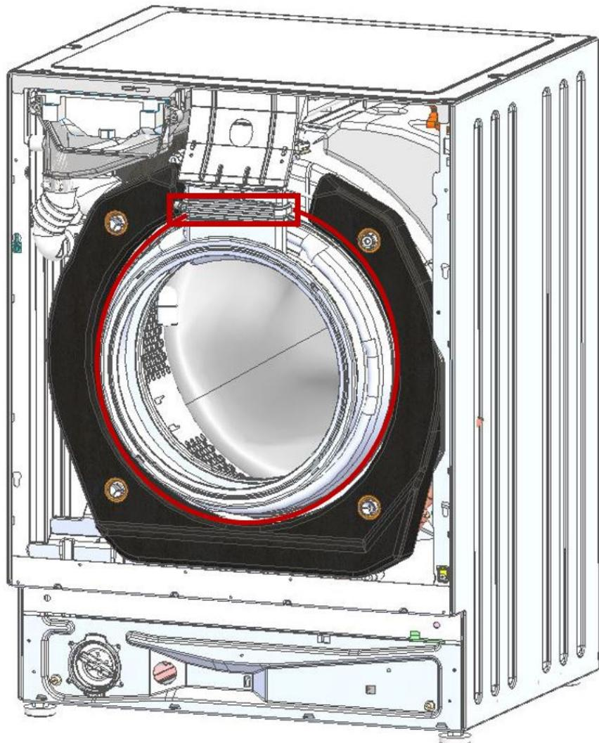
8. Fjern festeringen for pakningen på plastrøret (7 mm pipenøkkel)
