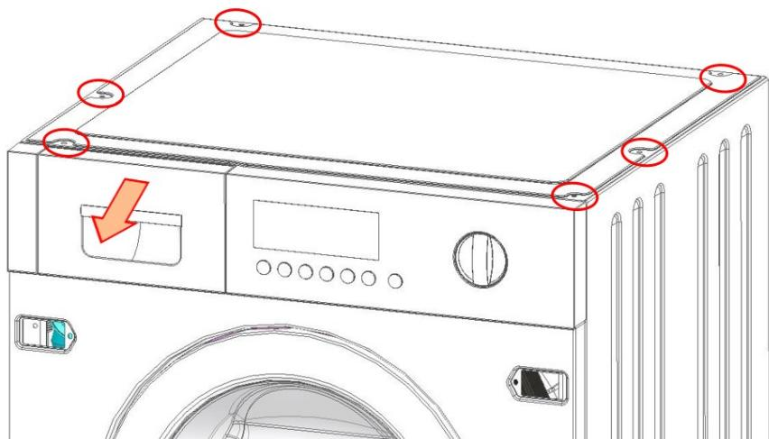
2. Fjern skruene i betjeningspanelet (1-2-3-4).
