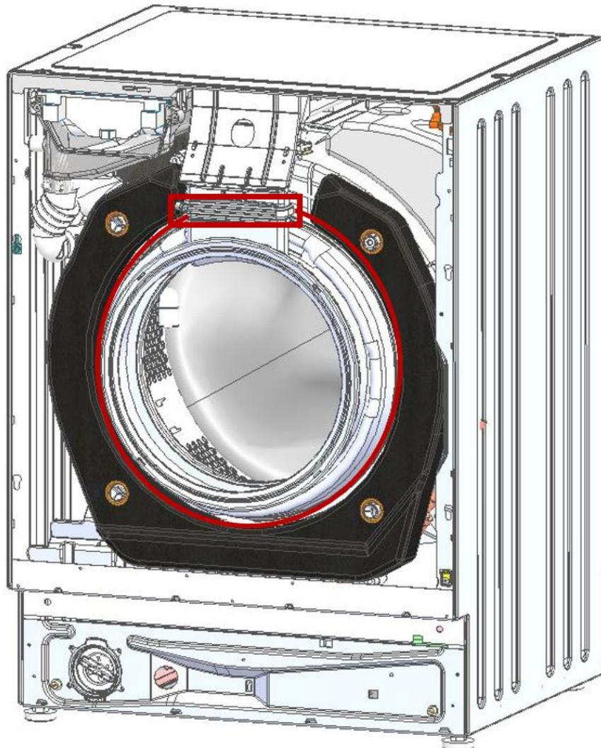
8. Rimuovere l'anello di fissaggio della guarnizione sulla vasca di plastica (bussola da 7 mm)
