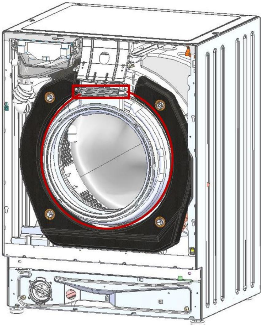
8. Remova o anel de fixação da junta no tubo de plástico (chave de caixa de 7 mm)
