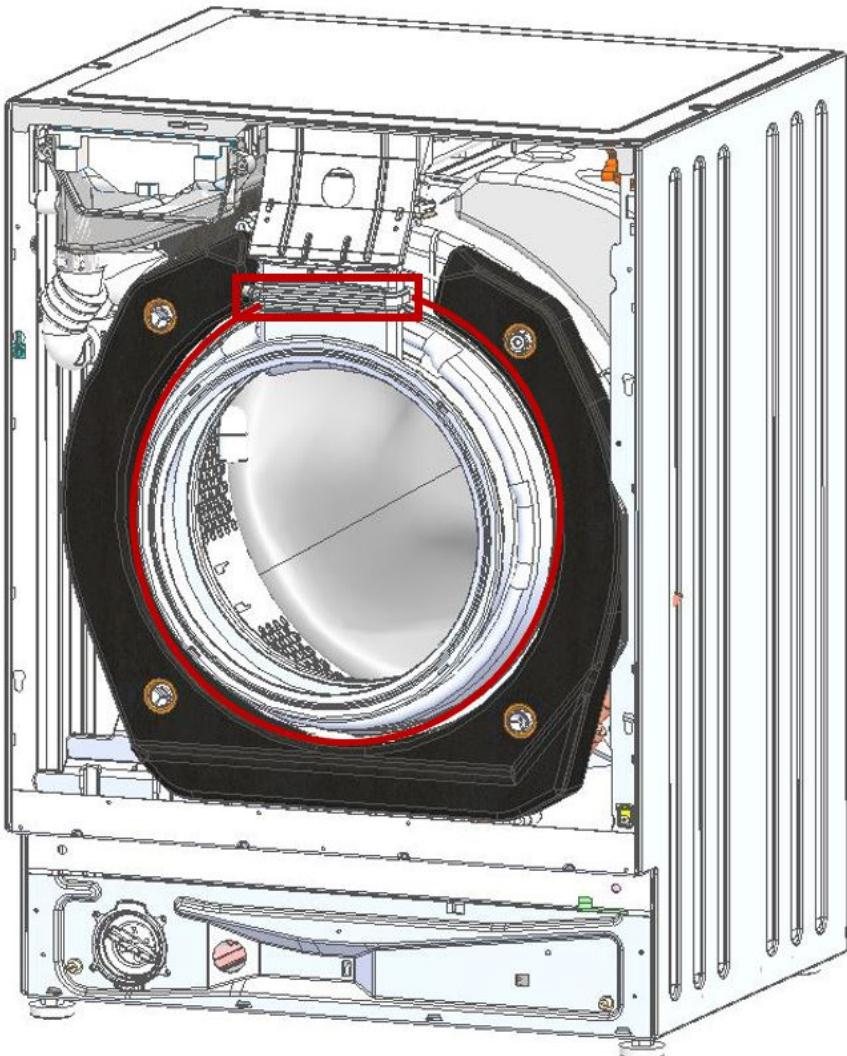
8. Verwijder de bevestigingsring van de afdichting aan kunststof kuip (7 mm steek-sleutel)
