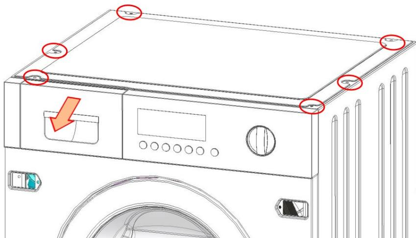
2. Verwijder de schroeven aan het bedieningspaneel (1-2-3-4).
