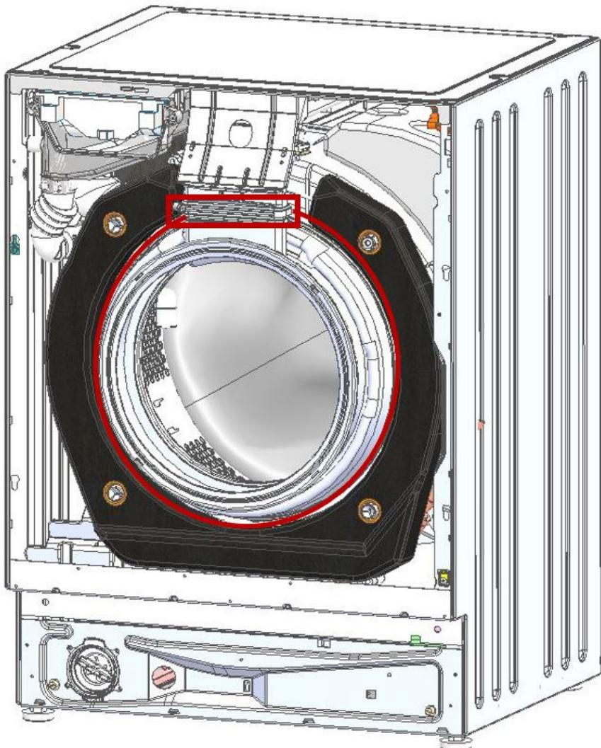
8. Отстранете фиксиращия пръстен на уплътнението на пърба на барабана (7 мм гаечен ключ).
