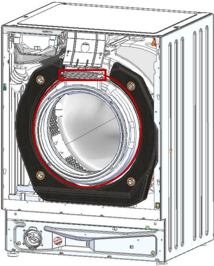
8. Retirer l'anneau de fixation de la manchette de la cuve en plastique (clé à douilles de 7 mm).
