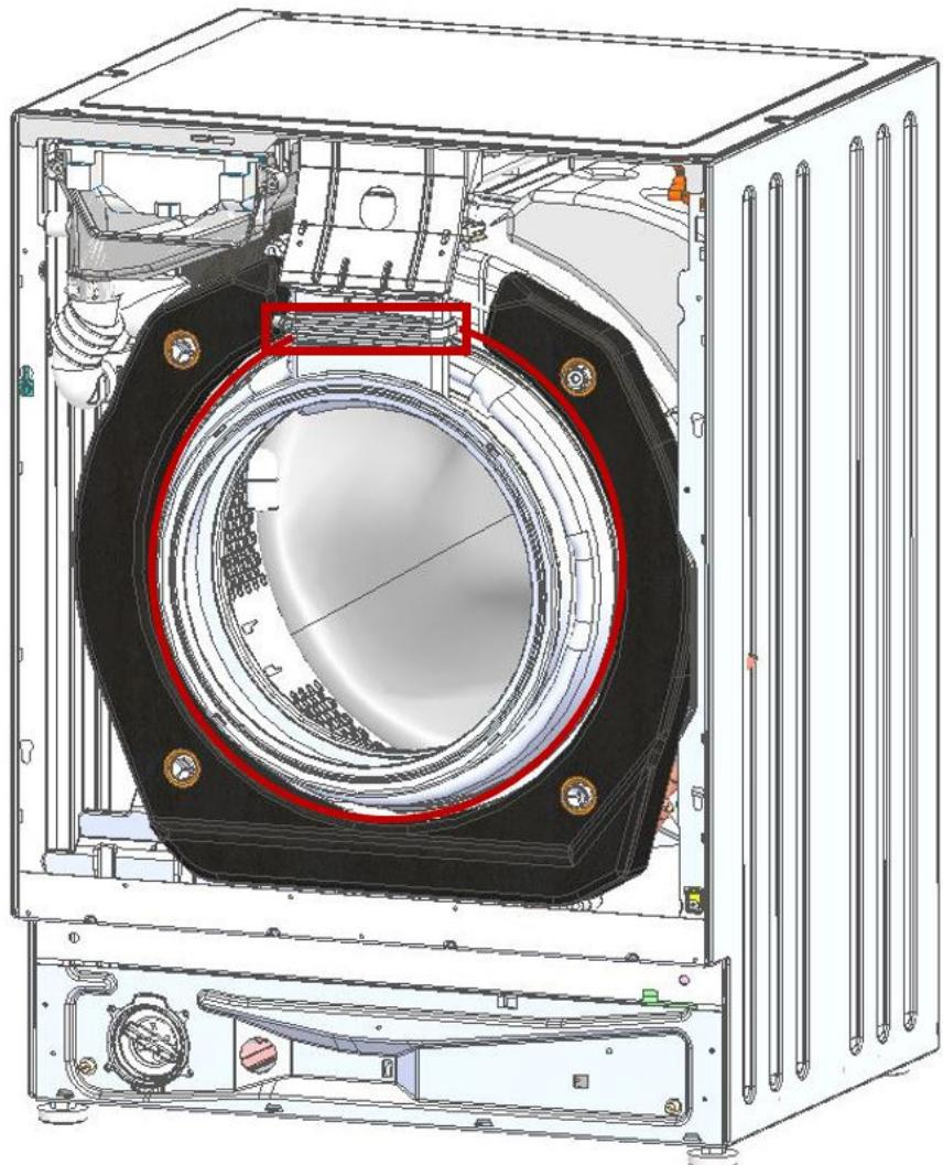
8. Retirar el anillo de fijación de la junta en la cubeta de plástico (llave de tubo de 7 mm).
