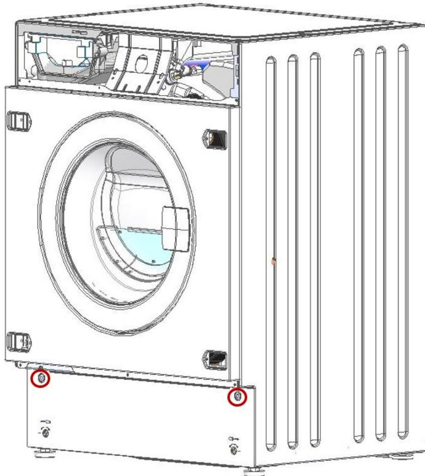
2. Die Sockelabdeckung durch drehen nach unten entfernen.
