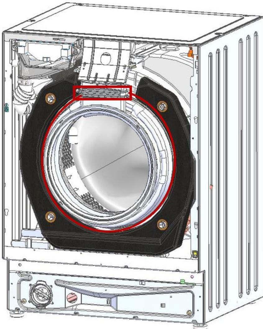
8. Odstraňte upevňovací kroužek těsnění na plastové vaně (nástrčný klíč 7 mm).
