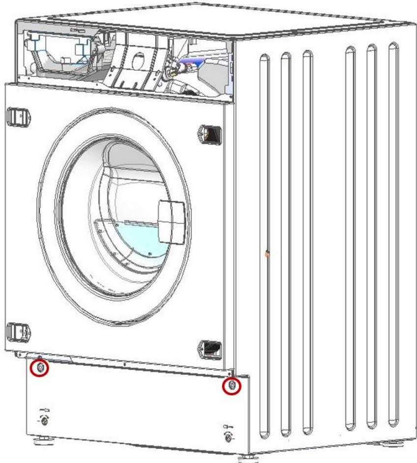
2. Verwijder de sokkelklep door de klep naar beneden te draaien.
