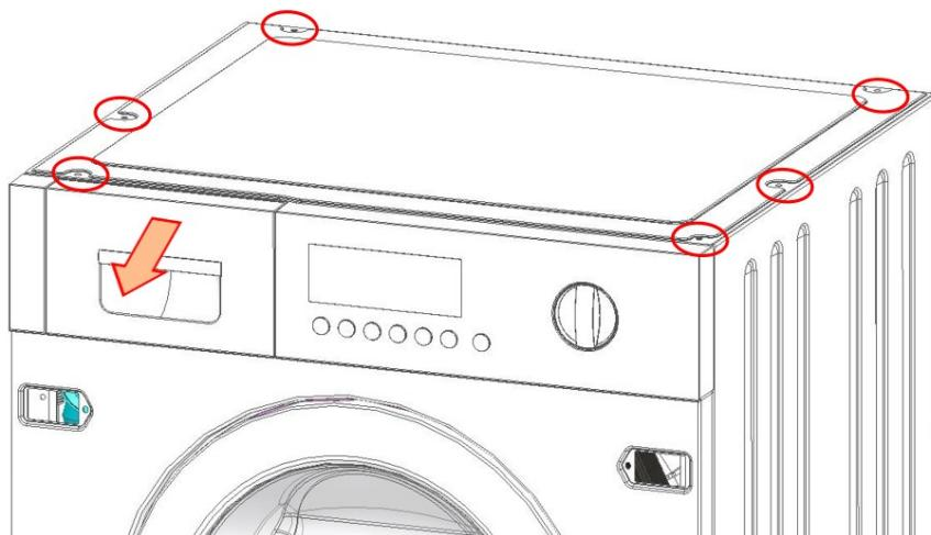
2. Ta bort skruvarna på manöverpanelen (1-2-3-4).
