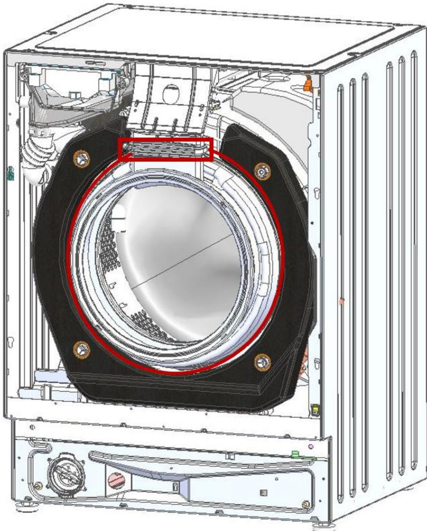
8. Poista tiivisteen kiinnitysrengas muoviputkesta (7 mm:n hylsyavaimella)
