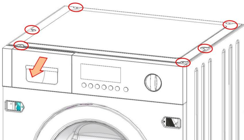
2. Die Schrauben (1-2-3-4) an der Bedienblende entfernen.
