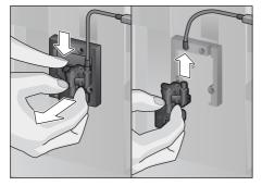
■ 取下导奶管。拆卸饮料出口的上下部件。
