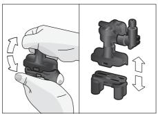
■ 拆开导奶管、连接件以及牛奶软管。
