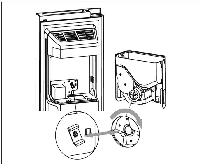
1. Asigurați-vă că cele două cuplaje sunt poziționate într-un unghi adecvat reciproc pentru a se între-pătrunde. Dacă este necesar, rotiți cuplajul de la nivelul recipientului pentru cuburi de gheață, astfel încât să se potrivească cuplului motorului.
