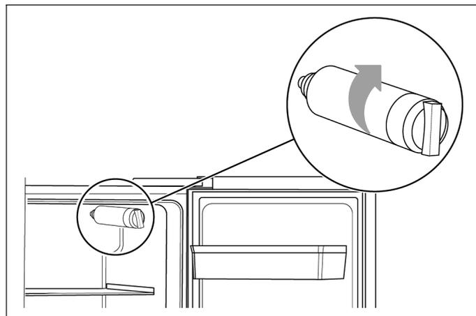
1. Uvrnite novi filtari za vodu u smjeru kazaljke na satu i provjerite čvrst dosjed filtra u grlu.
