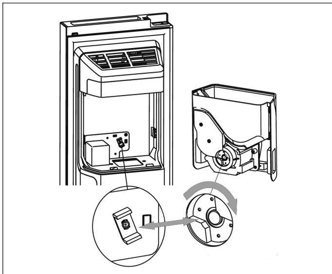
1. Prepričajte se, da je kot med obema spojka primeren, da spojki ležeta ena v drugo. Po potrebi obrnite spojko na predalu za ledene kocke, da se bo prilegala na spojko motorja.
