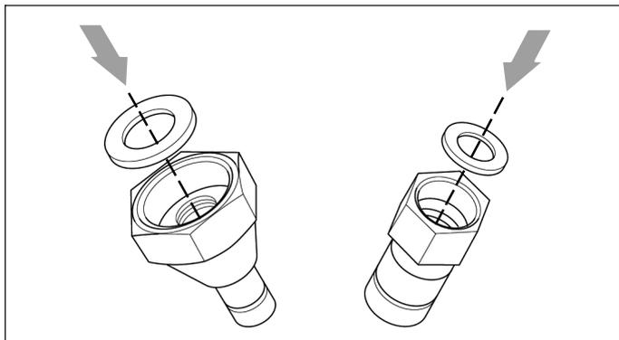
2. Introduceți inelele de etanșare în conexiunile furtunului.
