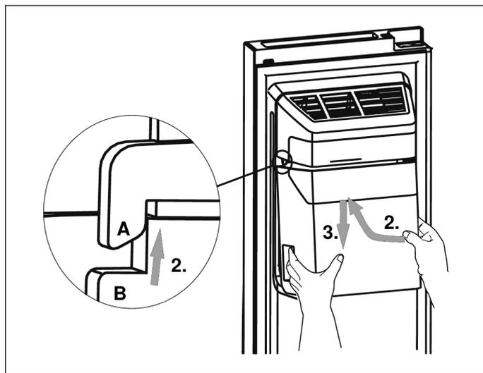
2. Fixați recipientul pentru cuburi de gheață de mâner și împingeți-l în sus. Asigurați-vă că recipientul pentru cuburi de gheață (B) se fixează pe ambele laturi în clemele (A) ale aparatului de producere a gheții.
