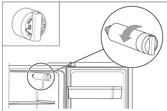
2. Odvrnite stari filter za vodu suprotno od smera kretanja kazaljke na satu (videti oznaku na filteru) i izvadite ga.
