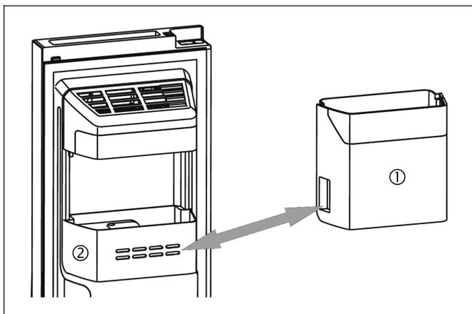
Dacă nu este nevoie de gheață, aparatul de producere a gheții poate fi oprit și se poate utiliza un compartiment de depozitare montat la nivelul ușii (2) în locul recipientului pentru cuburi de gheață (1) pentru a beneficia de mai mult spațiu în congelator.
