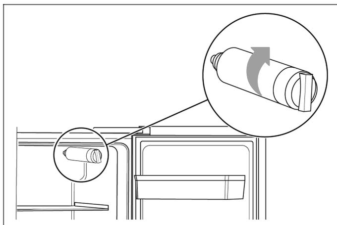
4. Uvrnite filter za vodu u smjeru kazaljke na satu i provjerite čvrst dosjed filtra u grlu.
