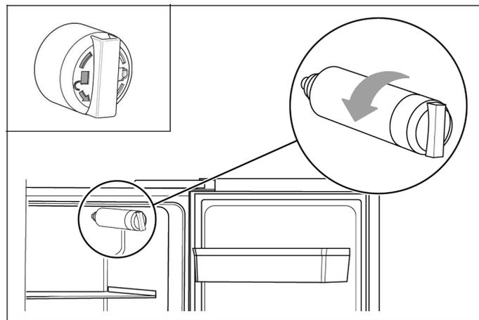
2. Odvrnite stari filtari za vodu u smjeru suprotnom od kazaljke na satu (pogledajte oznaku na filtru) i izvadite ga.
