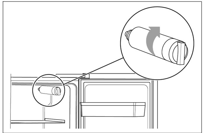
4. Înșurubați filtrul de apă în direcția acelor de ceasornic și asigurați-vă că filtrul este poziționat corespunzător în soclu.
