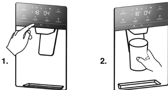
1. Pritisnite tipko
