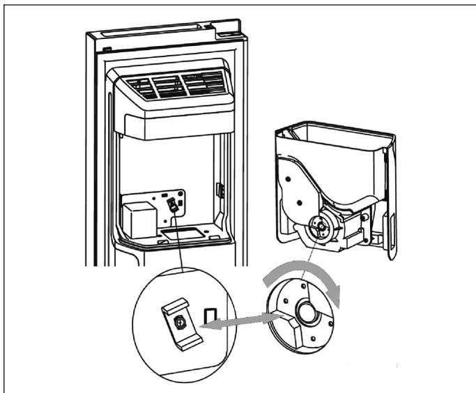
1. Prepričajte se, da je kot med obema spojkama primeren, da spojki ležeta ena v drugo. Po potrebi obrnite spojko na predalu za ledene kocke, da se bo prilegala na spojko motorja.
