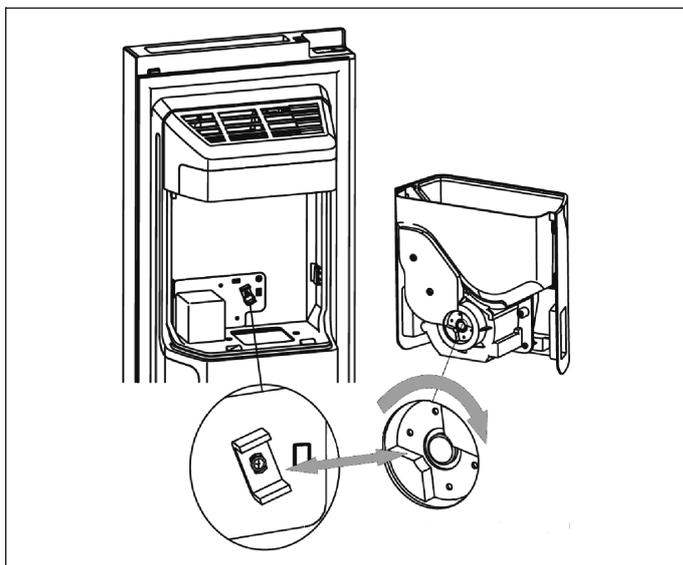
1. Asigurați-vă că cele două cuplaje sunt poziționate într-un unghi adecvat reciproc pentru a se întrepenetra. Dacă este necesar, rotiți cuplajul de la nivelul recipientului pentru cuburi de gheață, astfel încât să se potrivească cu cuplul motorului.
