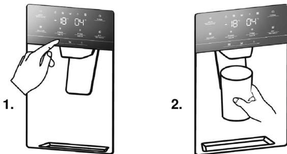
1. Натиснете бутона
