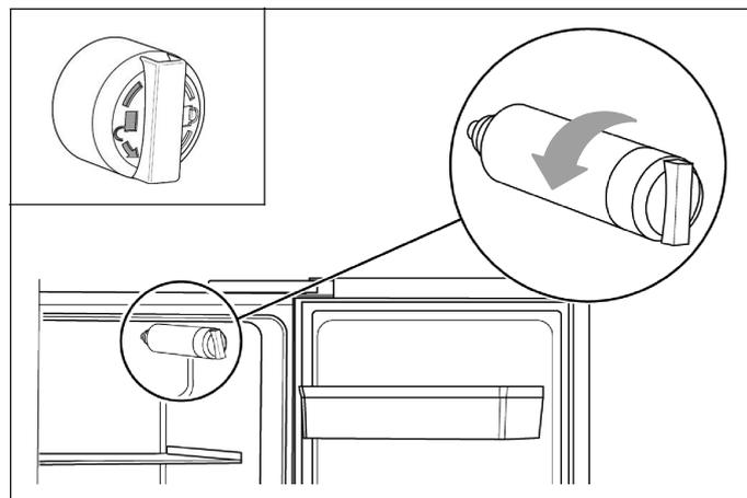
2. Stari vodni filter odvijte v levo (glejte oznako na filtru) in ga odstranite.
