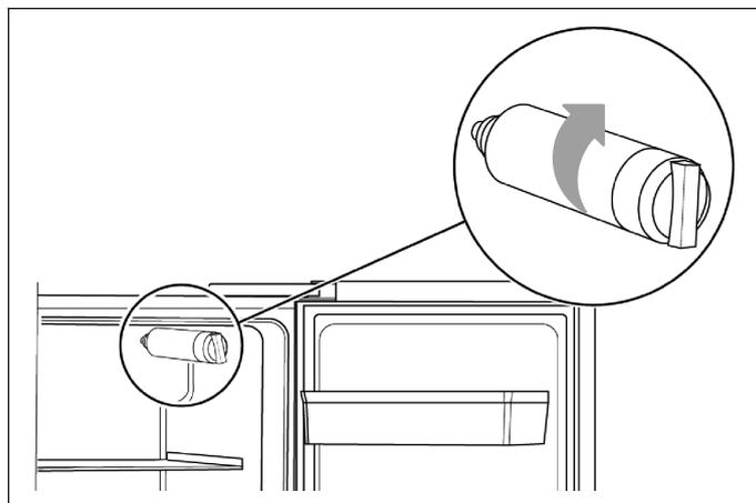
4. Vodni filter privijte v desno in se prepričajte, da je trdno nameščen v podstavek.
