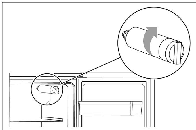
1. Uvrnite novi filtarski element za vodu u smjeru kazaljke na satu i provjerite čvrst dosjed filtra u grlu.
