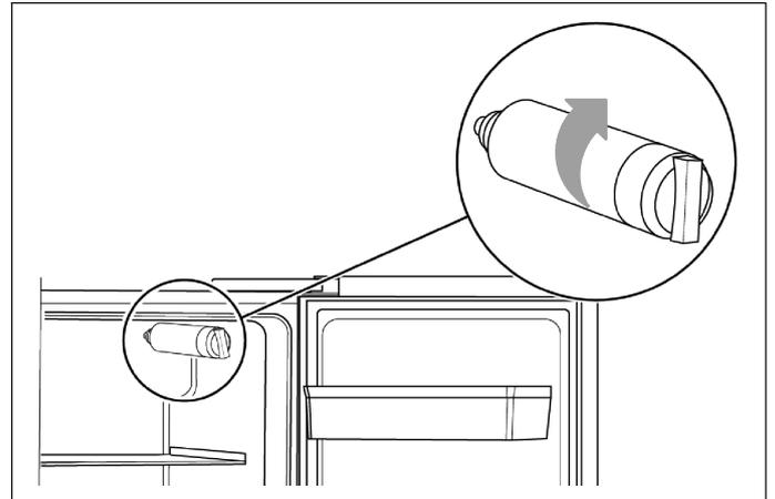
4. Înșurubați filtrul de apă în direcția acelor de ceasornic și asigurați-vă că filtrul este poziționat corespunzător în soclu.
