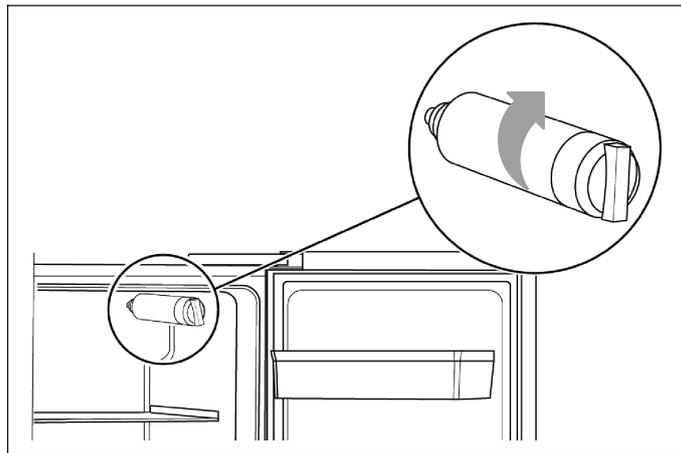
1. Novi vodni filter privijte v desno in se prepričajte, da je trdno nameščen v podstavek.
