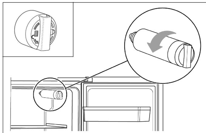
2. Deșurubați vechiul filtru de apă prin rotirea în sensul opus acelor de ceasornic (a se vedea marcajul filtrului) și demontați-l.
