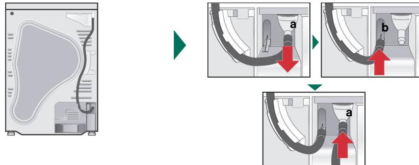
Estado de la secadora en el momento de la entrega: la manguera para la evacuación del agua condensada en el depósito para agua condensada está fijada a la boquilla de conexión.
