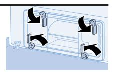
Retirez soigneusement toutes les peluches du couvercle de l'échangeur thermique et du filtre à peluche.
