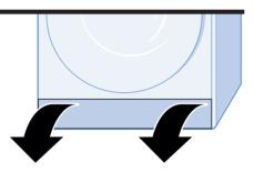
Déverrouillez les leviers du couvercle de l'échangeur thermique et retirez la poignée.
