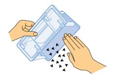
Rincez l'intérieur du couvercle de l'échangeur thermique et du filtre à peluches à l'eau courante, puis séchez avec un chiffon. En cas de fort encrassement, utilisez une brosse douce.
