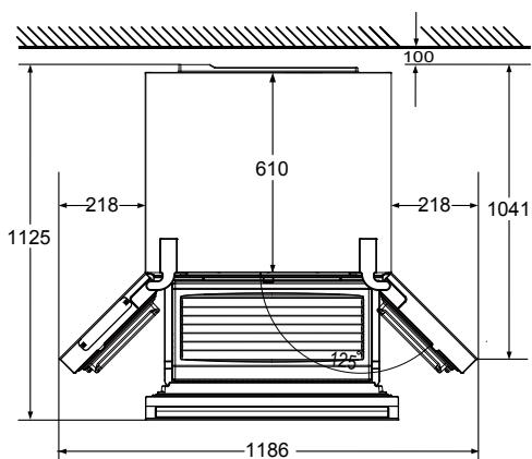
若临近的厨房设备高度不超过 830 毫米，开门角度可达到最大化。若临近的厨房设备高度超过 830 毫米，同时设备厚度达到以下规定值，则须遵守最小边距规定，才能保证开门角度达到最大化。
