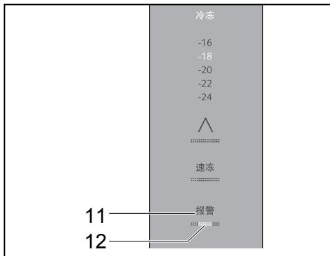
触摸报警按钮11，关闭蜂鸣器的报警声。当箱内温度低于报警温度时，报警指示灯将自动熄灭。
