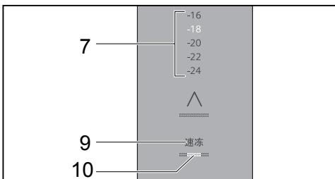
若一次性冷冻大量食品，应提前打开速冻功能，让冷冻室降至较低温度，再放入食品。
