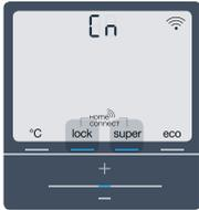
Prima as duas teclas exatamente em simultâneo. A operação das teclas é bloqueada, se for premida apenas a tecla **"lock/alarm off"** por um longo período de tempo. Prima novamente a tecla **"lock/alarm off"**, até o bloqueio ser anulado.
