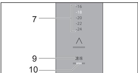
若一次性冷冻大量食品，应提前打开速冻功能，让冷冻室降至较低温度，再放入食品。
