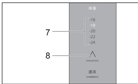
停止操作5秒钟后，最后的温度设定值被确认并储存。
