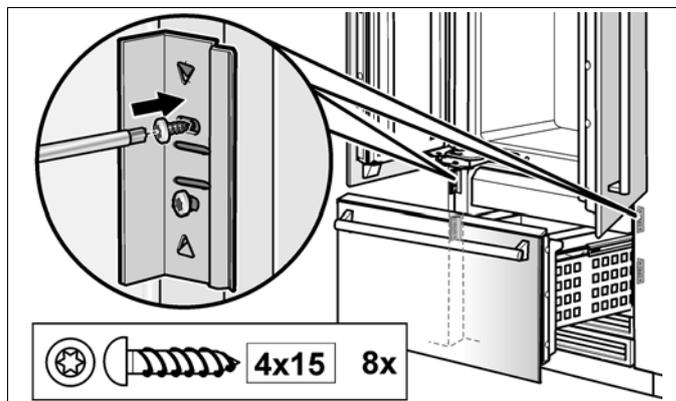
2. Aplicar as barras de cobertura (c) nas placas de fixação (b) e nos ângulos (a).
