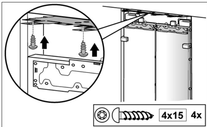
3. Quando existir espaço suficiente por cima do aparelho, fixar as nervuras laterais das placas de fixação (em cima) consoante as condições de montagem.
