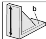
O calibre de montagem (b) é utilizado para ajustar correctamente esta altura. A aresta superior do calibre deve coincidir com a marcação existente no aparelho.
