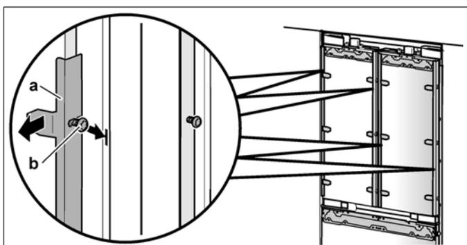
2. Introduzir os ângulos de fixação retirados (a) nas calhas de fixação (b) na porta do móvel.
