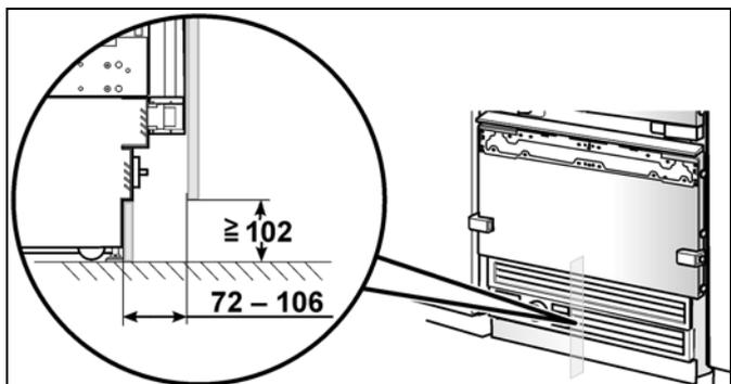
1. Se for necessário, cortar a barra do rodapé para o comprimento exigido.
