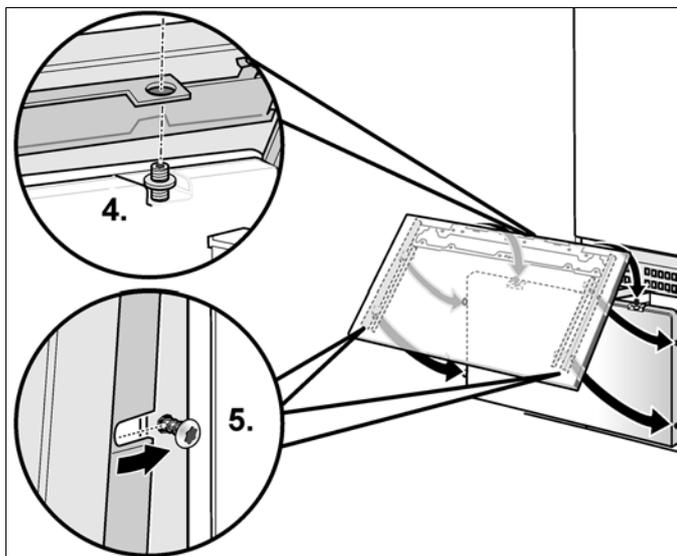
6. Alinhar a porta do móvel com o pino roscado (aparafusadora Torx). Controlar frequentemente a medida da fenda.
