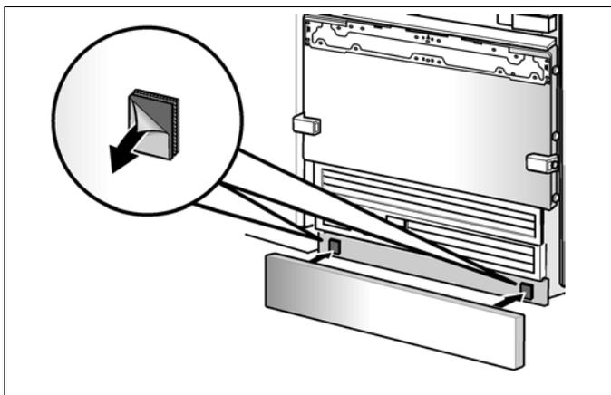
5. A barra do rodapé pode ser aparafusada ao revestimento do rodapé pela parte traseira. Para este efeito, o revestimento do rodapé está provido de furos.
