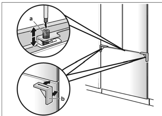
3. Transferir a posição dos parafusos de fixação na aresta exterior da porta do aparelho para a porta do móvel e efectuar uma marcação.
