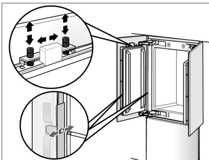
10. Rodar e apertar as porcas nos pinos roscados da barra de ajuste! Deste modo, é fixado o alinhamento lateral da porta.
