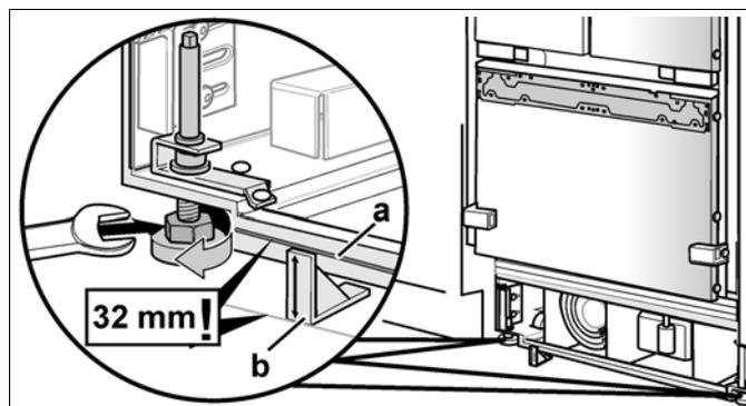
3. Alinhar o aparelho na vertical, com os pés na traseira. Utilizar o nível de bolha de ar!
