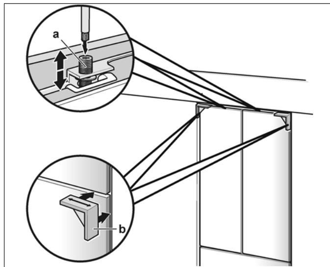
3. Transferir a posição dos parafusos de fixação na aresta exterior da porta do aparelho para a porta do móvel e efectuar uma marcação.
