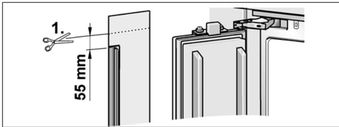
2. Empurrar a parte restante cortada situada no lado do batente para a fenda existente entre o aparelho e a parede do nicho.
