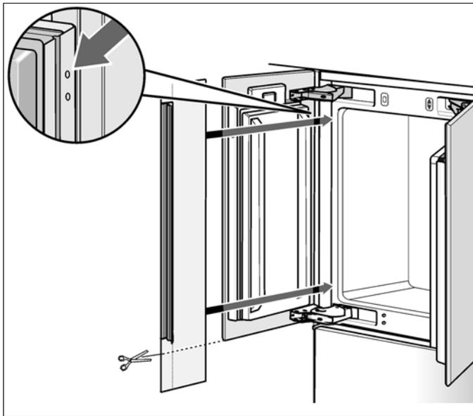
2. Inserir a protecção dos dedos no espaço entre o aparelho e a parede do nicho (1.).
