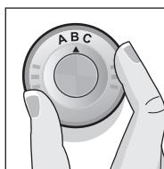
Obroč za aroma na spodnji strani filtrirnega vložka za filtriranje vode nastavite na ugotovljeno stopnjo.
