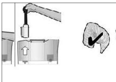
**i** Le rinçage du filtre a activé le paramètre d'affichage du message « Remplacer le filtre à eau svp ». Une fois que ce message est apparu ou au bout de 2 mois au plus tard, le filtre n'est plus efficace. Il faut alors le remplacer pour des raisons d'hygiène et afin que l'appareil ne s'entartre pas (cela pourrait l'endommager).
