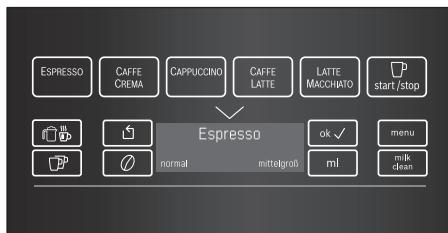
**i** De volautomatische espressomachine is af fabriek geprogrammeerd met de standaardinstellingen voor een optimale werking. De machine wordt na een gekozen tijd automatisch uitgeschakeld (zie hoofdstuk "Menu – Auto. uitschakeling").
