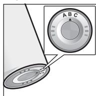
Utilice la tira de prueba adjunta para determinar el ajuste óptimo del regulador de filtrado.
