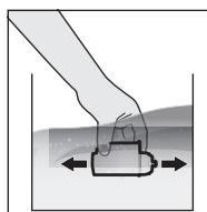
Dompel de waterfilterpatroon onder in koud water en beweeg hem voorzichtig heen en weer, om alle luchtbellen te verwijderen.
