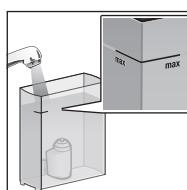
Wyciągnij zbiornik i napełnij go zimną wodą do poziomu oznaczenia „max”.
