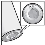
Pour déterminer le réglage de la bague de réglage d'arôme, utilisez la bandelette de test ci-jointe.
