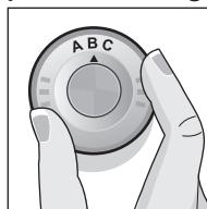
Ajuste el regulador de filtrado de la parte inferior del cartucho filtrante al nivel determinado.
