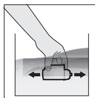
Filtre kartşunu soğuk suyun içine daldırın ve hava kabarcıklarının tümünü çıkarmak için filtreyi hafifçe hareket ettirin.
