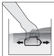
Coloque o cartucho de filtragem de água por baixo de água fria e agite-o levemente para eliminar todas as bolhas de ar.
