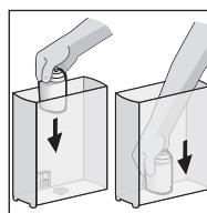
Sonra filtreyi elinizle (eğer varsa toz ölçüğünün yardımıyla) su deposunun içine sıkica oturtunuz.
