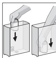
Em seguida coloque o cartucho de filtragem de água manualmente (se houver, com ajuda da colher-medida de café) firmemente no depósito de água.
