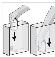
Plaats de waterfilterpatroon aansluitend met de hand (of, indien beschikbaar, met behulp van de maatlepel) in het waterreservoir.
