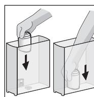
Anschließend setzen Sie die Wasserfilterkartusche mit der Hand (falls vorhanden mit Hilfe des Pulverlöffels) im Wassertank fest auf.
