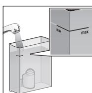
Теперь выньте емкость для воды и наполните ее холодной водой до отметки «max».
