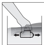
Drücken Sie die Wasserfilterkartusche unter kaltes Wasser und schwenken Sie sie leicht, um alle Luftblasen zu entfernen.
