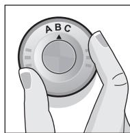
Regolare la ghiera posta sul lato inferiore del filtro per il filtraggio dell'acqua sul livello rilevato.
