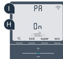
**Σύνδεση ανεπιτυχής:** Βεβαιωθείτε, ότι το Smartphone ή το Tablet PC σας βρίσκεται στο οικιακό δίκτυο (WLAN). Επαναλάβετε τις διαδικασίες στο βήμα 3. Σε περίπτωση που στο πεδίο ενδείξεων εμφανίζεται «**Er**», μπορείτε να επαναφέρετε το ψυγείο σας. Περισσότερα για την επαναφορά και περαιτέρω συμβουλές θα βρείτε στις οδηγίες χρήσης.
