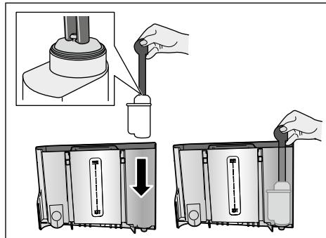
4. Наполните контейнер водой до отметки «max».
