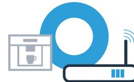
No caso da ligação manual, a sua máquina de café configura uma rede WLAN própria (Soft Access Point), à qual se pode ligar com o seu smartphone ou tablet.
