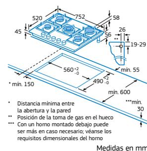
\*Los inyectores de gas natural funcionan a 20 mbar y los de gas butano a 28-30/37 mbar.
