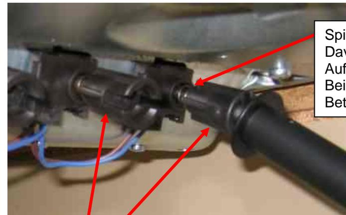
Spiralfeder auf Zündschalter. Davor (zwischen Feder und Aufnahmestück) sitzt noch Beilagescheibe für sichere Betätigung des Schalters
