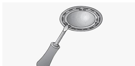
3. Vervang de halogeengloeilamp (gewone halogeengloeilamp, 12 V, max. 20 watt, voetje G4).
