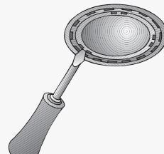
3. Changez l'ampoule halogène (ampoule halogène en vente habituelle dans le commerce, 12 volts, 20 watts maxi., douille G4).
