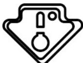
La «Zona para alimentos delicados» está caracterizada en el frigorífico mediante la flecha que se muestra en la imagen. Según el modelo de aparato concreto, la «Zona para alimentos delicados» se encuentra situada en la parte inferior del mismo, entre la flecha lateral estampada y la balda de vidrio que se encuentra debajo de ésta, entre ambas flechas o, en caso de no haber flechas estampadas, en todo el interior del frigorífico, excepto en la zona de la puerta.
