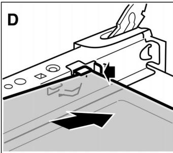
1. Die Glasscheibe schräg nach hinten einschieben. (Bild D)
