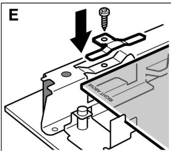
2. Die Klammern aufsetzen und festschrauben. (Bild E)
