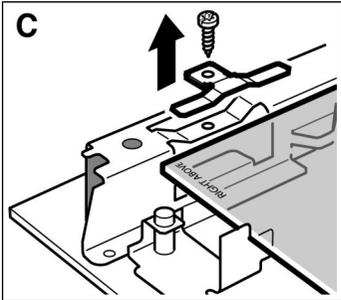
4. Die Klammern rechts und links aufschrauben und entfernen. (Bild C)
