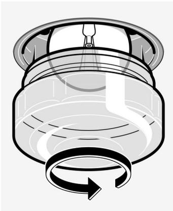
Wenn die Backofenlampe ausgefallen ist, muss sie ausgewechselt werden. Temperaturbeständige Ersatzlampen, 40 Watt, erhalten Sie beim Kundendienst oder im Fachhandel. Verwenden Sie nur diese Lampen.
