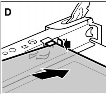
1. Engager la vitre inférieure en l'inclinant vers l'arrière. (Fig. D)
