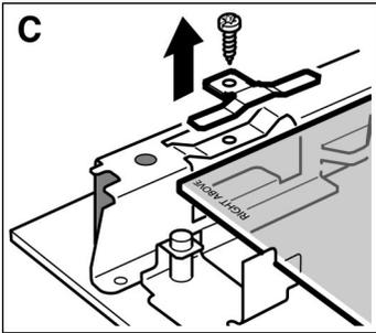
4. Dévisser les pattes à droite et à gauche et les enlever (Fig. C). Retirer la vitre.
