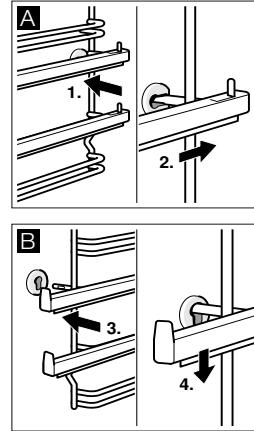
**de** Der Aus- und Einbau ist für alle Auszugsvarianten gleich. Je nach Gerätetyp müssen Sie die Grundeinstellungen auf "Teleskopauszug: ja" ändern. Sehen Sie dazu bitte in der Gebrauchsanleitung im Kapitel *Grundeinstellungen* nach.
