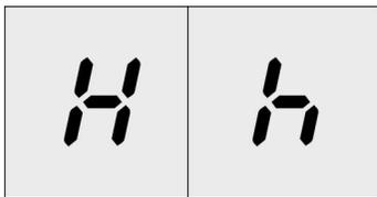
Płyta bez własnego sterowania ma dla każdej płyty z własnym sterowaniem wskaźnik ciepła resztkowego. Pokazuje on, które płyty z własnym sterowaniem są jeszcze gorące. Wskaźnik ciepła resztkowego jest dwustopniowy.
