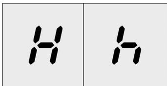
Для каждой конфорки на варочной панели предусмотрен индикатор остаточного тепла. Этот индикатор показывает, какая конфорка еще горячая. Индикатор остаточного тепла показывает две степени нагрева.
