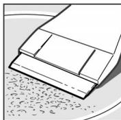
Silná znečištění nejlépe odstraní škrabkou na sklo.
