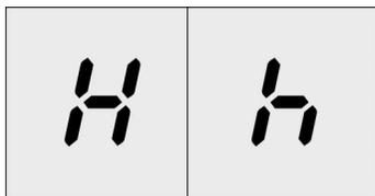
Varná deska má pro každou varnou zónu ukazatel zbytkového tepla. Ten indikuje, které varné zóny jsou ještě horké. Ukazatel zbytkového tepla má 2 stupně.
