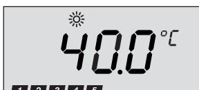
Het doorstroomtoestel kan met voorverwarmd water (bijvoorbeeld uit het zonnewarmte-systeem) gebruikt worden. Bedraagt de toevoertemperatuur meer dan 30 °C, brandt in het display het „zon-symbool”.
