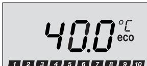
Het bijk mengen van koud water met de mengkraan leidt tot onnodig verbruik van water en energie. Stel de gewenste watertemperatuur daarom op het doorstroomtoestel zelf in en open de waterkraan.
