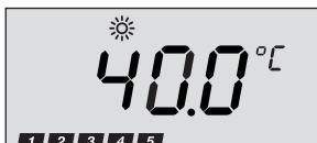
Der Durchlauferhitzer kann mit vorgewärmtem Wasser (zum Beispiel aus der Solaranlage) betrieben werden. Ist die Zulauftemperatur über 30 °C, leuchtet im Display „Symbol Sonne“ auf.
