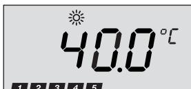
Проточный водонагреватель может работать с предварительно нагретой водой (например из солнечной установки). Если температура подвода превышает 30 °C, на дисплее загорается „символ солнца“.
