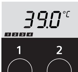
Les deux programmes sont répétés jusqu'à ce que soit appuyée la **touche 1 ou 2** en fonction du programme activé, le robinet reste fermé pendant plus de 2 minutes ou jusqu'à ce que la température soit modifiée. La température ajustée avant le démarrage du programme est maintenant de nouveau activée.
