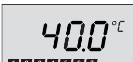
La puissance momentanément absorbée du chauffe-eau est indiquée en segments de 10 % au moyen de l'affichage de puissance.
