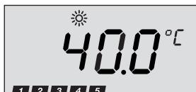
O esquentador pode ser operado com água pré-aquecida (por exemplo de uma instalação solar). Se a temperatura de entrada estiver acima de 30 °C, no display aparece o “símbolo sol”.
