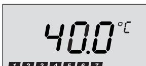
Mit der Leistungsanzeige wird die momentan aufgenommene Leistung des Durchlauferhitzers in 10%-Segmenten angezeigt.
