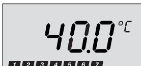
На индикации мощности отображается потребляемая в данный момент мощность проточного водонагревателя в 10%-сегментах.
