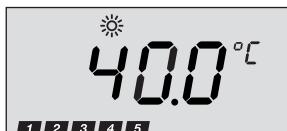
El calentador de agua funcionará también con agua precalentada (procedente por ejemplo de un sistema de energía solar). Si la temperatura de entrada del agua es mayor de los 30 °C, en el display se ilumina el “símbolo sol”.
