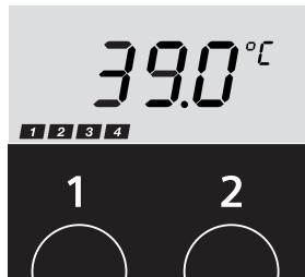
Beide programma's worden net zo lang herhaald, tot al naar gelang het gekozen programma **toets 1 of 2** wordt ingedrukt, de waterkraan langer dan 2 minuten gesloten wordt, of de temperatuur gewijzigd wordt. De voorafgaand aan de program mastart ingestelde temperatuur is opnieuw geactiveerd.
