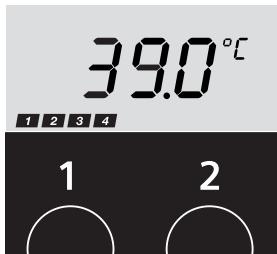
Обе программы повторяются до тех пор, пока в зависимости от выбранной программы, нажата **кнопка 1** или **2**, пока водопроводный кран не закроется больше чем на 2 минуты, либо пока не изменится температура. Теперь снова становится активной температура, установленная перед запуском программы.
