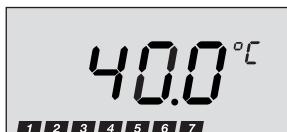
Con la indicación de potencia se indica en forma de segmentos de 10 % la potencia consumida momentáneamente por el calentador de paso.
