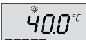
Le chauffe-eau peut être exploité avec de l'eau préchauffée (par exemple avec de l'eau provenant de l'installation solaire). Si la température d'alimentation est supérieure à 30 °C, le « Symbole soleil » apparaît à l'écran.
