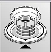
enroskar el filtro cilíndrico. ¡PRESTAR ATENCIÓN A LA POSICIÓN DE LA MARCA!
