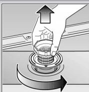
Girar el filtro cilíndrico y extraer el conjunto de filtros ...
