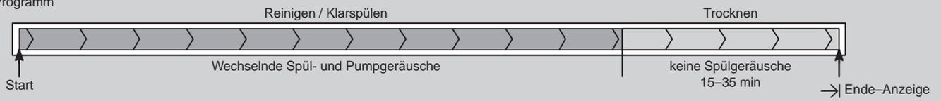
Nach dem Trocknen wird ca. 60 sec. abgepumpt. Das Programm ist erst beendet, wenn die Ende-Anzeige → leuchtet
