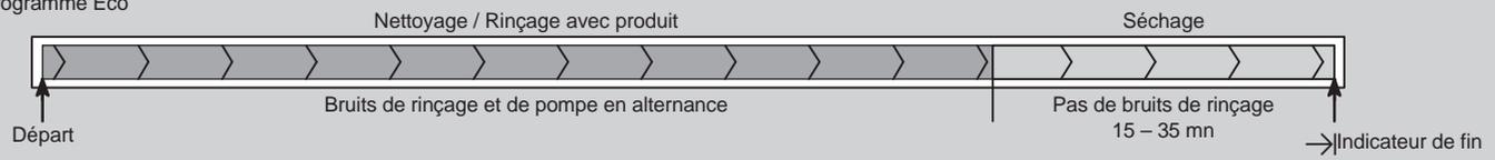
Après le séchage, la pompe fonctionne pendant 60 secondes environ. Le programme n'est terminé que lorsque l'indicateur de fin s'allume.
