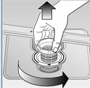
Siebzylinder drehen, Siebssystem entnehmen ...
