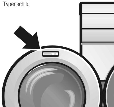
Sie finden diese Angaben auf dem Typenschild im Rahmen des geöffneten Einfüllfensters und im dick umrandeten Feld des Geräteschildes auf der Rückseite des Gerätes.
