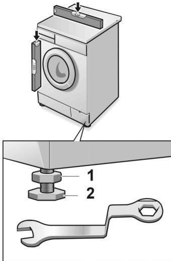
Waschmaschine mit Hilfe der vier verstellbaren Gerätetüße und einer Wasserwaage ausrichten:
